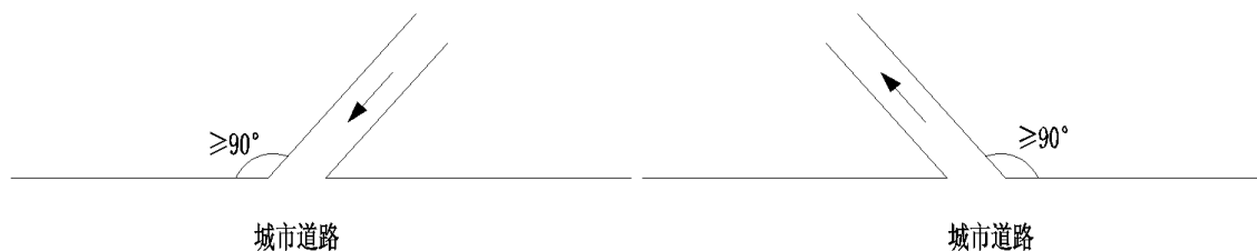
图 4.2.12-2 单向出入口通道的设置
